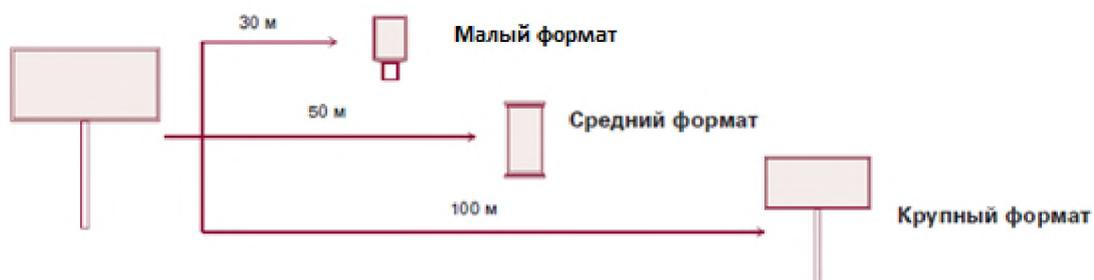
Рисунок 27. Минимальные расстояния между рекламными конструкциями разных типов и видов ».
