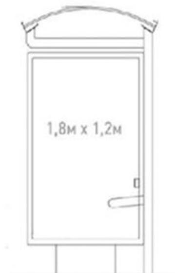
Рисунок 6. Рекламная конструкция в составе остановочного пункта движения общественного транспорта
