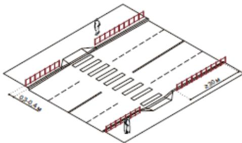
Рисунок 4. Пешеходные ограждения в местах пересечения пешеходных путей с проезжей частью без светофорного регулирования
