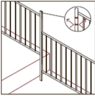
Рисунок 3. Ограждение на разных уровнях поверхности
