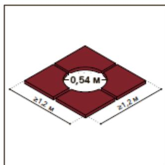
Рисунок 29. Рекомендуемый размер защитной приствольной решётки
