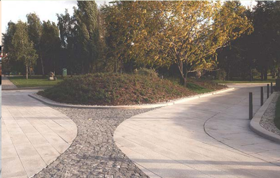
МЕЛКАЯ БРУСЧАТКА ДЛЯ СТЫКОВ используется на стыках поверхностей
