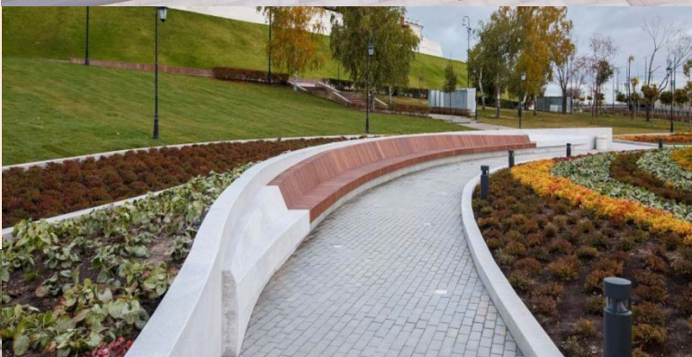
ПОДПОРНАЯ СТЕНКА СО СКАМЕЙКАМИ (убежище) монолитный бетон, дерево (места для сиденья)
