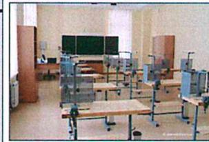
• УЧЕБНО-ПРОИЗВОДСТВЕННЫЕ ПОМЕЩЕНИЯ ПО ИЗУЧЕНИЮ ТЕХНОЛОГИИ ОБОРУДОВАНЫ ВЕРСТАКАМИ, РАССТАВЛЕННЫМИ ПОД УГЛОМ К СВЕТОНЕСУЩЕЙ СТЕНЕ, ТАК ЧТОБЫ СВЕТ ПАДАЛ СЛЕВА. ВЕРСТАКИ ОСНАЩЕНЫ ПРЕДОХРАНИТЕЛЬНОЙ СЕТКОЙ
